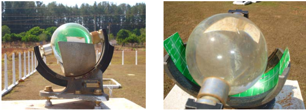
FIGURA 1. Heliógrafo da estação climatológica da Escola de Agronomia e Engenharia de Alimentos da UFG. Heliograph of climatologic station of School of Agronomy and Food Engineering from UFG, Brazil.
