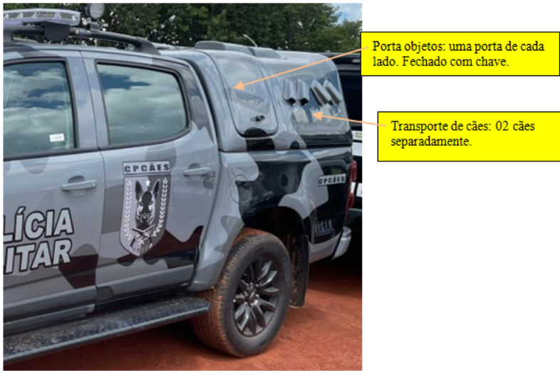
Imagem 1: modelo da carroceria coberta, com local para transporte de materiais e local para transporte de cães.
